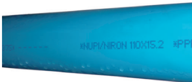
Estado de tubería NIRON con condensación superficial.
